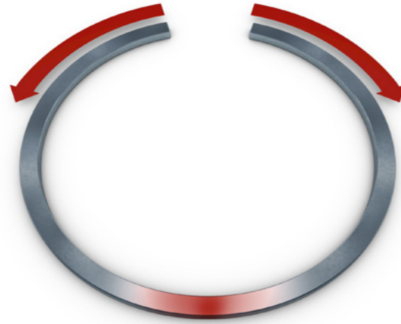
Şek. 1: Piston segmanının pistonun üzerine aşırı çekilmesi
