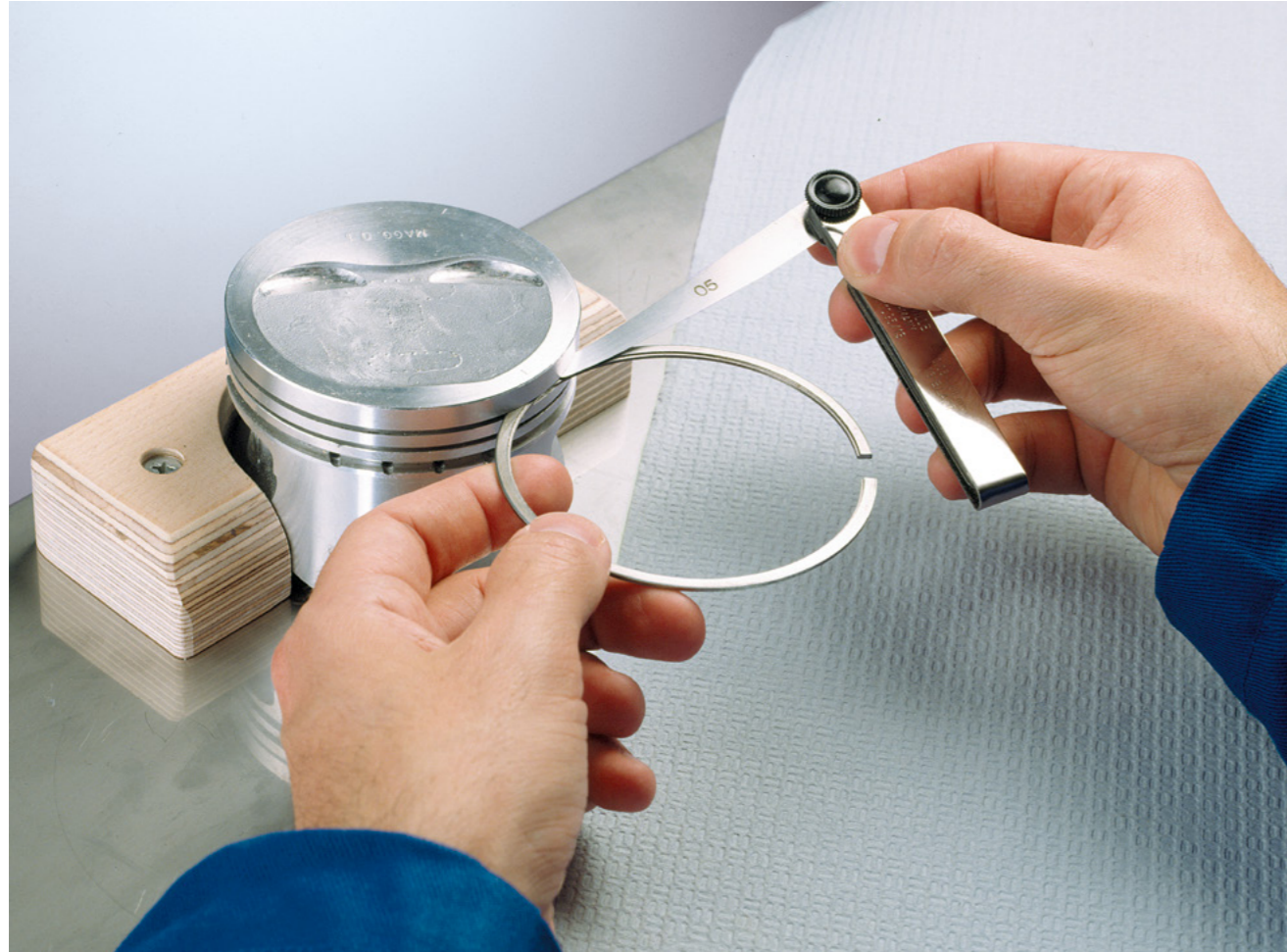
Şek. 1: Segman yüksekliği boşluğunun ölçülmesi
