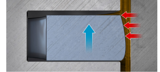
Şek. 4: Yukarı hareket sırasındaki kuvvetli süzülme
