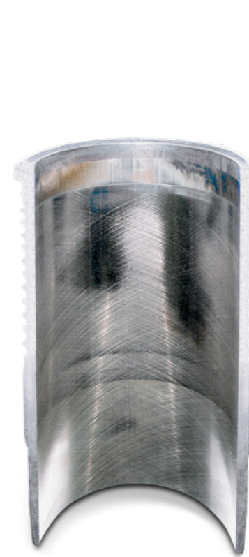
Şek. 2: Üst silindir bölgesindeki parlak kısımlar ve perdah yerleri
