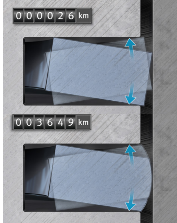
Şek. 1: Alışma aşınması ile sağlanan yuvarlaklık
