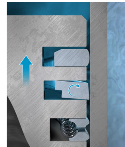
Şek. 5: Yanma basıncı yok
