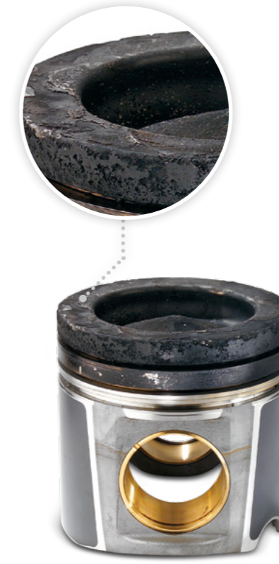
Şek. 3: Yanma yolundaki yağ karbon tabakası
