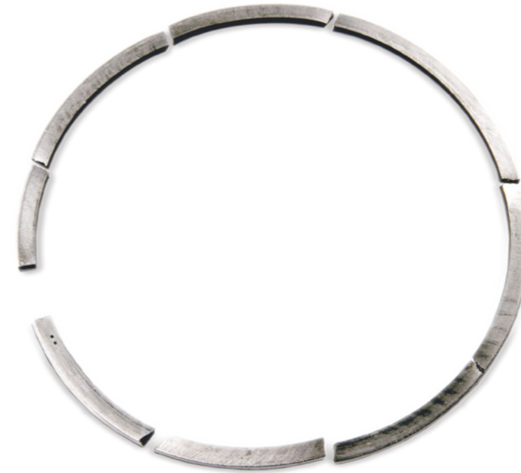
Kırılmış piston segmanı
