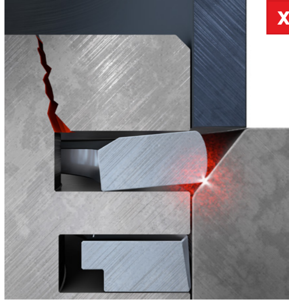
Şek. 1: Silindir deliğinde çok fazla kenar pahı – Piston segmanı montaj sırasında piston segmanı sıkıştırma bandı ile silindir arasında yaylanır ve piston bloke olur
