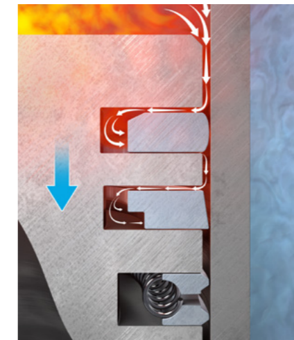
Şek. 6: Yanma basıncı var
